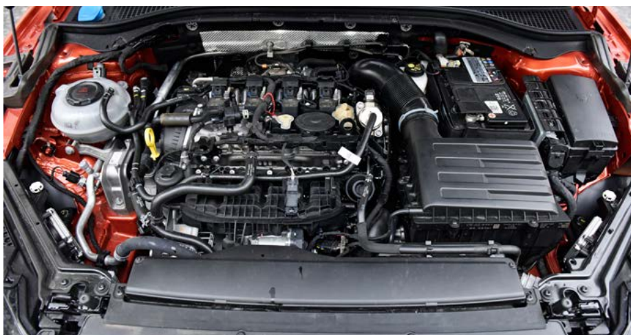
Motor Audi EA 888 (2.0 TSI/140 kW) s přímým i nepřímým vstříkáváním paliva použitý ve voze Škoda Superb.
