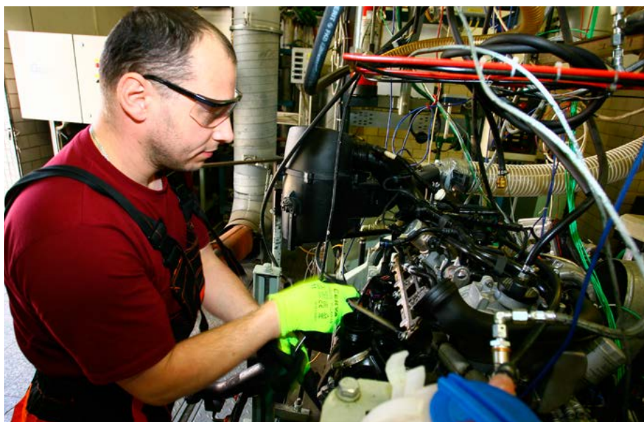
Při zkoušce SGS DISI se sleduje parametr doby vstřiku z řídicí jednotky, neboť je úměrný zanášení vstřikovače. Následuje demontáž, focení a opětovné čištění vstřikovačů pro další provoz. Přísada VIF Super Benzin Aditiv některé vstřikovače vyčistila tak, že doba vstřiku byla kratší než na začátku testu.
