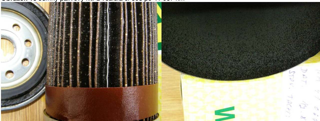
Obrázek 17 Hrubý palivový filtr z vozidla č. 603 po 41 067 km
