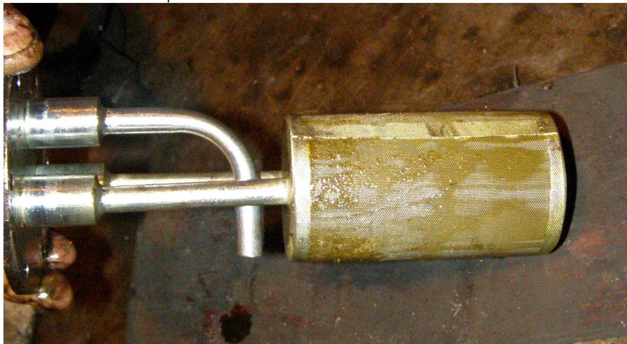
Obrázek 12 Předfiltr na sání paliva v nádrži autobusu SOR BN10.5
