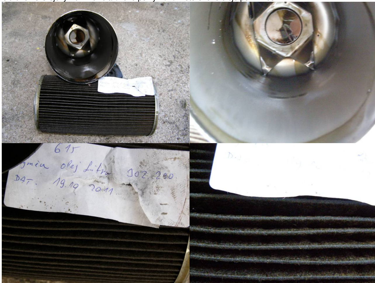
Obrázek 10 Jemný palivový filtr z vozidla č. 450 po 1 950 km
