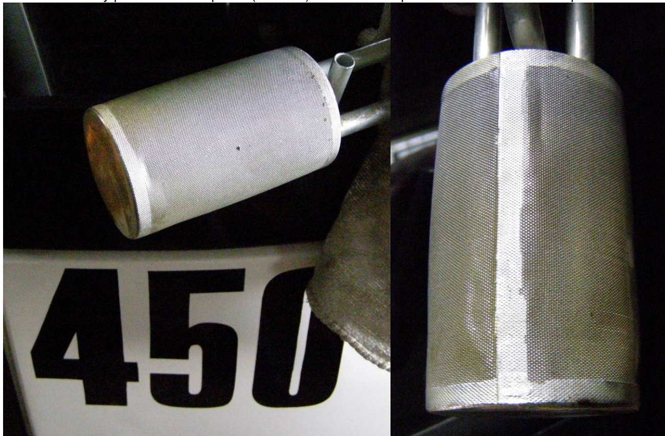
Obrázek 18 Čistý předfiltr na sání paliva (sací koš) vozidla č. 450 po 4 měsících sledovaného provozu
