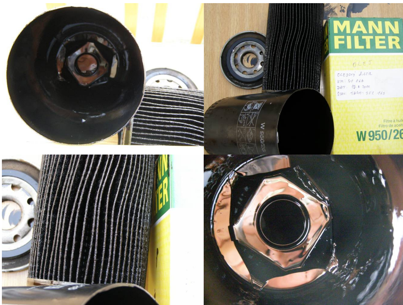
Obrázek 8 Olejový filtr z vozidla č. 603 po výměně motorového oleje po 41 067 km
