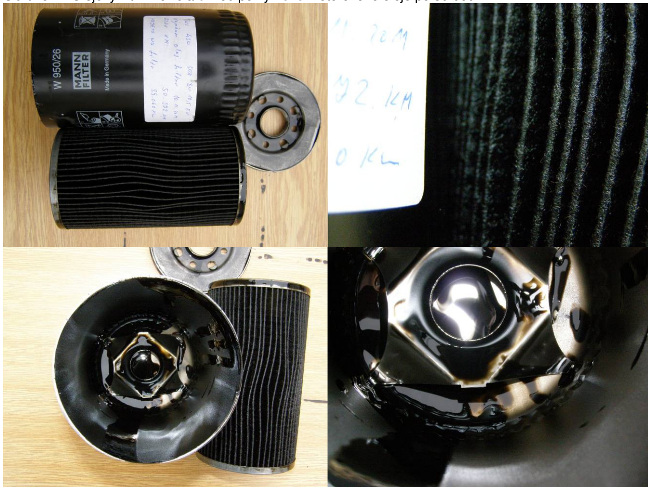
Obrázek 7 Olejový filtr z vozidla č. 450 po výměně motorového oleje po 39 060 km
