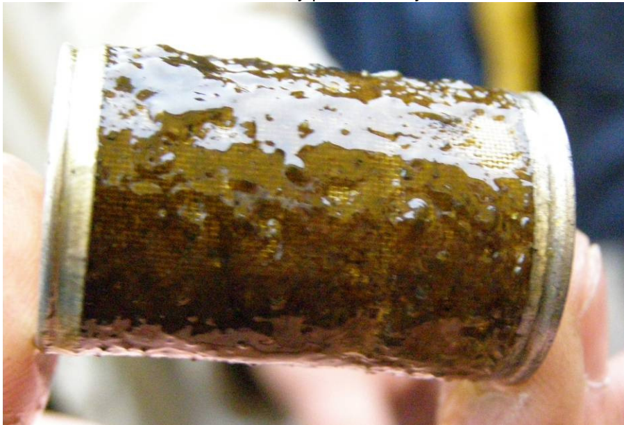
Obrázek 16 Jemný palivový filtr z vozidla č. 603 po 41 067 km
