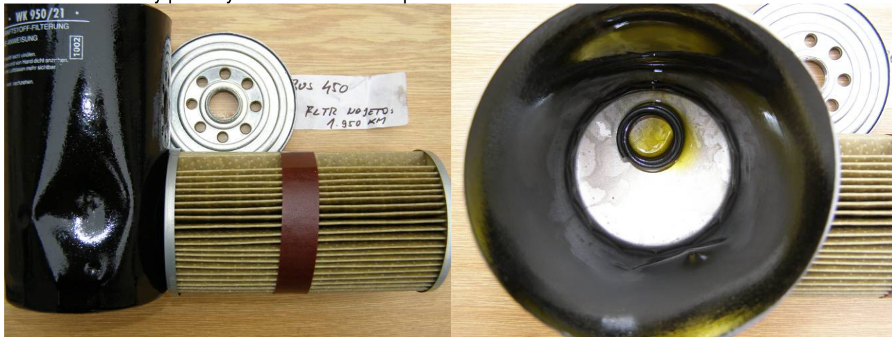
Obrázek 10 Jemný palivový filtr z vozidla č. 450 po 1 950 km
