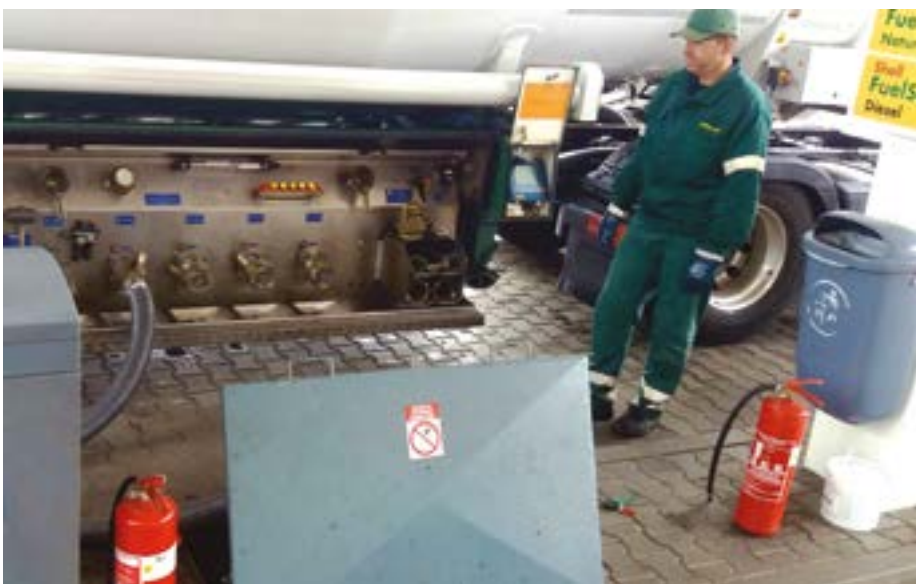
SPRÁVNĚ: Na snímku je řidič správně vybavený OOP (osobními ochrannými prostředky). Je zde také dobře vidět správné rozmístění hasicích přístrojů během stáčení.
