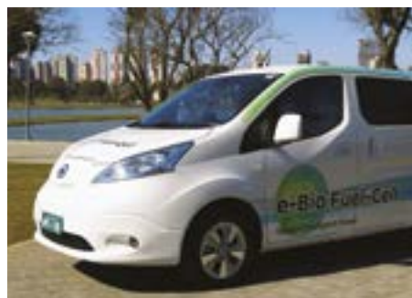
Prototyp vychází z lehkého užitkového elektromobilu e-NV200, který známe i z evropských silnic.
