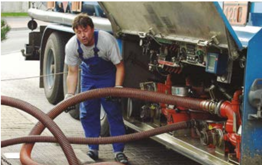
CHYBNĚ: Na snímku je řidič při stáčení v pantoflích, oděv nezakrývá celý povrch těla, chybí ochrana hlavy. Takto by to být nemělo.
