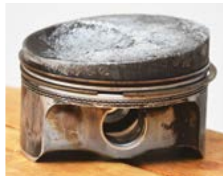
Píst z motoru 3.6 FSI poškozený detonačním spalováním kvůli zanesenému vstřikovači. Toto poškození je typické pro auta, která delší čas jezdí při nízké zátěži (v níž se vstřikovače zanášejí nejrychleji) a pak náhle prudce akcelerují.
