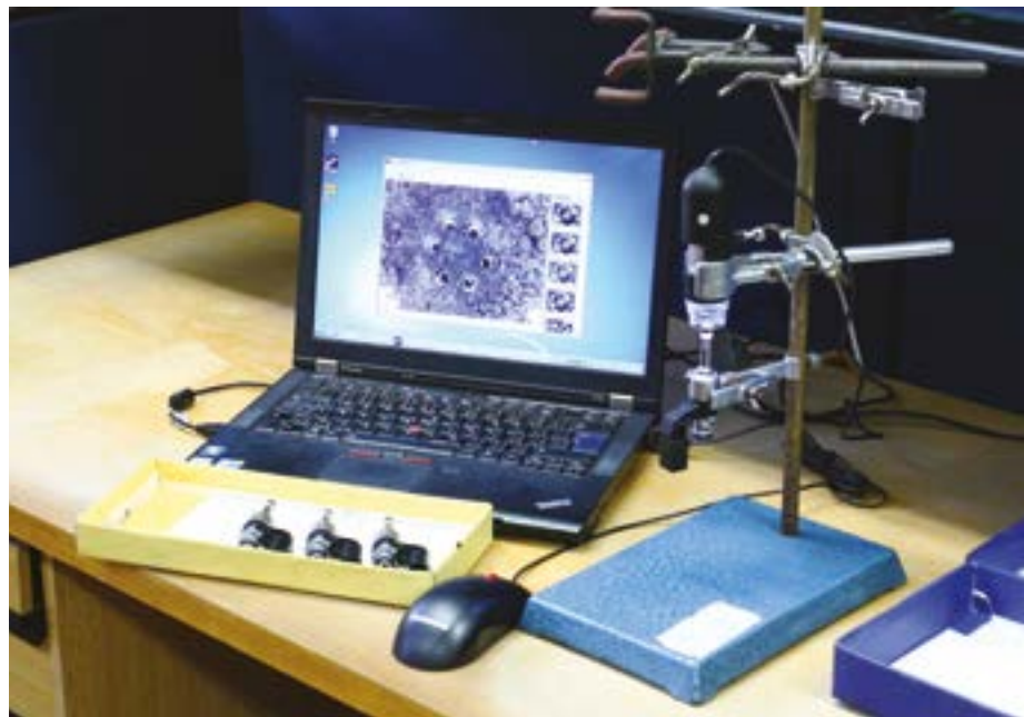
Fotka vstřikovačů pod mikroskopem po skončení čisticí fáze zkoušky je doplňkem protokolu. Hlavní vypovídací hodnotu má čas vstřiku určující míru jeho zanesení a opětovného vyčištění.
