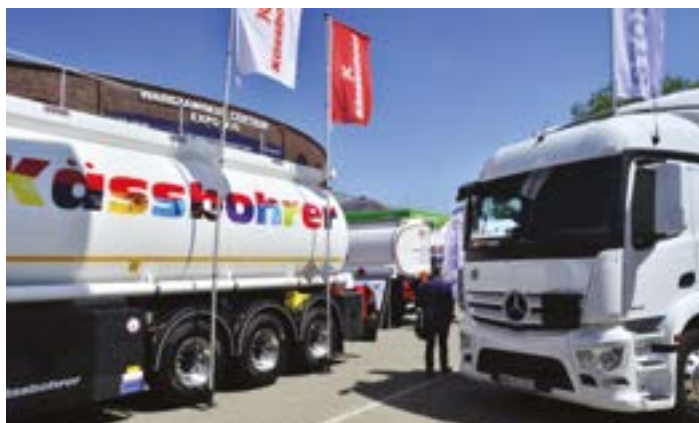
Nádrže firmy Kässbohrer pro přepravu kapalných paliv jsou vyrobeny výhradně z lehkého hliníku a mohou být vybaveny různými typy měřících systémů a tzv. el. pečeti.
