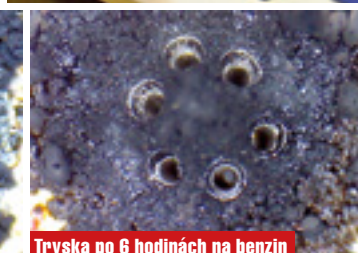
Tryska po 6 hodinách na benzin s přísadou Super Benzin Aditiv
