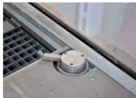
Otočná tryska pro mytí podvozku.
