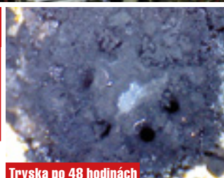
Tryska po 48 hodinách na standardní benzin
