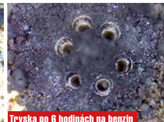
Tryska po 6 hodinách na benzin s přísadou Super Benzin Aditiv
