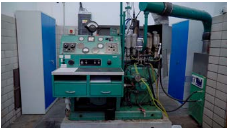
Oktanové číslo se stanovuje na jednoválcovém zkušebním motoru věhlasné americké firmy Waukesha. Má měnitelný kompresní poměr a snímač klepání. Při měření se používá porovnáni zkoušeného paliva s etalonem.
